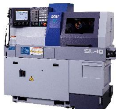
スイス型 CNC 自動旋盤 SL-10
