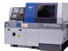
スイス型CNC自動旋盤 SR-20J II type B
