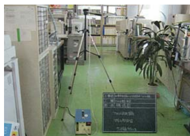
気中濃度測定の様子
