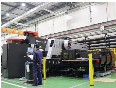
▲新規導入したレーザー加工機で金属板を切断
