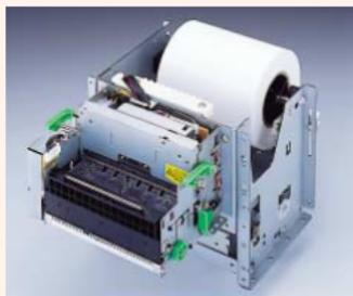
TUP900は、拡大が期待されるKIOSK(情報端末)市場に向けた、サーマルプリンタの新製品です。多様化する市場のニーズに対し、取り付けのフレキシビリティ、大きさ、性能などを大幅に改善するとともに、サーマルメカ、給紙ユニット、基板など製品の構成ユニット毎にモジュール化して製品設定することで、顧客による自由な選択を可能にしました。
