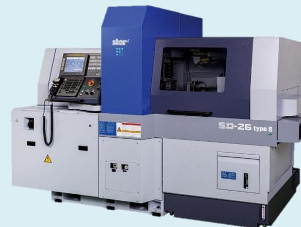
スイス型CNC自動旋盤 SD-26 type S
